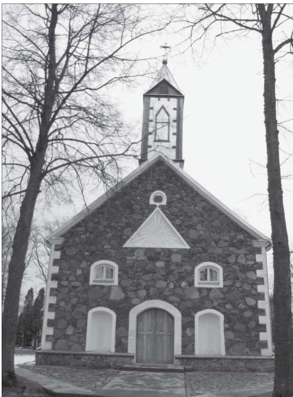
ir skirtingų faktūrų derinys. Didžiąją sienų paviršiaus dalį sudaro margas natūralaus akmens mūras. Pastato kampuose ir aplink angas jis padengtas baltintu nelygaus paviršiaus tinku. Priekinio fasado (13 pav.) centrinė dalis įrėminta mentėmis ir visa nutinkuota. Fasado ašį akcentuoja stambi pagrindinio įėjimo arka ir arkinis langas. Simetrijai nusižengia tik nedidelės stačiakampės šoninio įėjimo durys, apjuostos plačiu apvadu.
